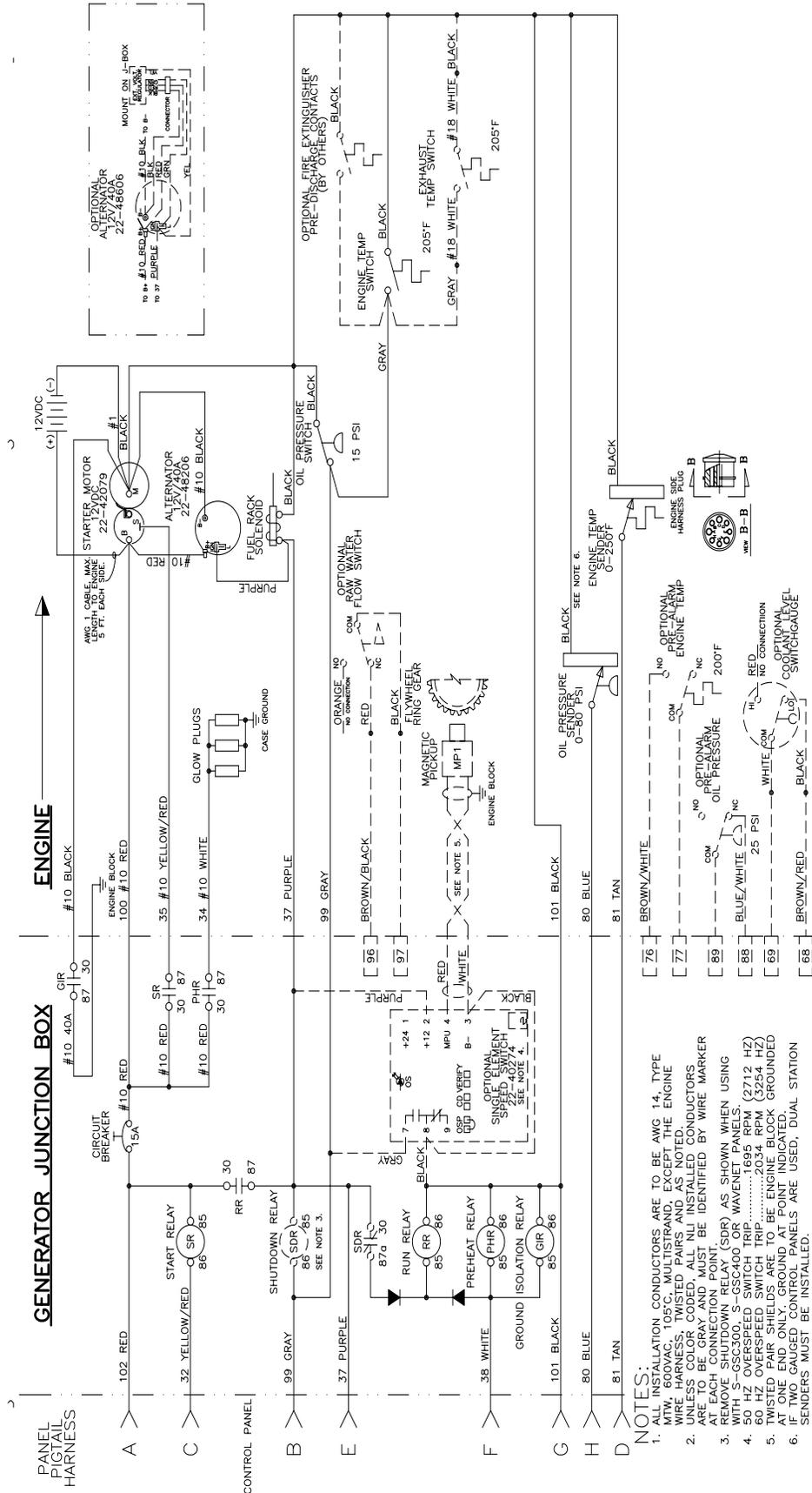
**DC Engine Wiring Diagram**
