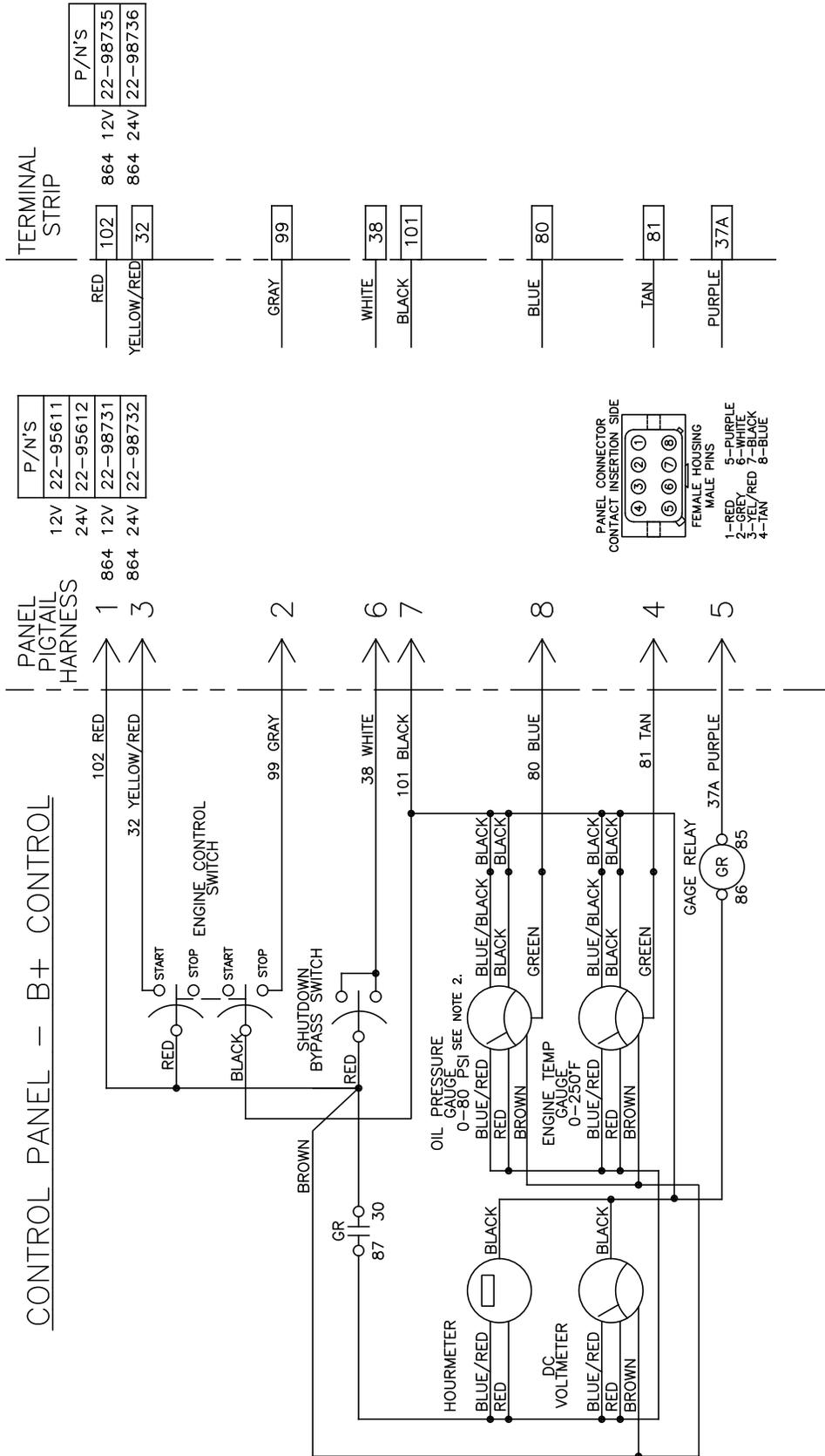
**Panel Wiring Diagram**
